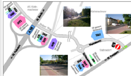
48% des an der Westrampe abfahrenden Durchgangsverkehrs fließt über den Schläusenweg auf die L 76 und 54% wieder innerhalb der 10h auf die Anschlussstelle A15 Klammachow Ostrampe.
